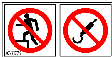
60325, 68776 – „Ne terhelje, ne emelje meg”
